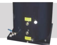
O dreno de óleo fica próximo do visor de nível e do bujão de enchimento, facilitando as inspeções periódicas.
